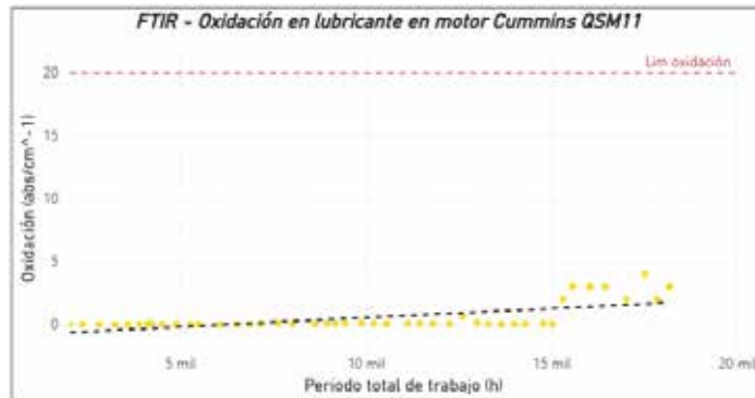
Fig. 6. Oxidación del lubricante a lo largo de la vida útil.
