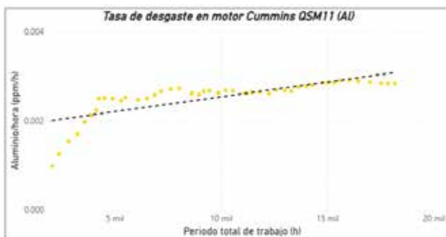
Fig. 4. Tasa de desgaste de Aluminio a lo largo de la vida útil.
