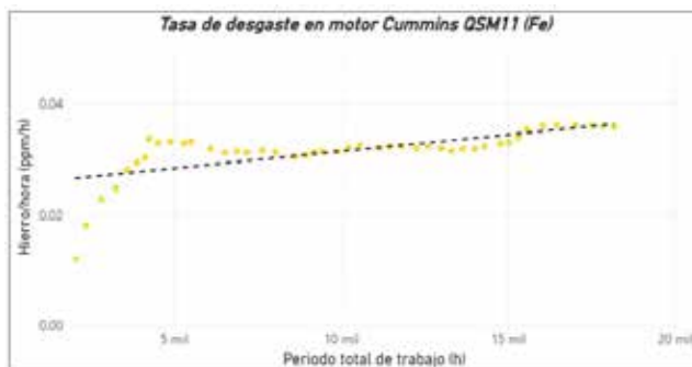
Fig. 3. Tasa de desgaste de hierro a lo largo de la vida útil.
